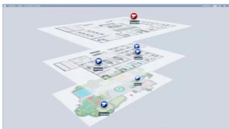
• **3D E-Map:** Mit der Lageplan-Funktion „3D E-Map“ haben Sie immer den Überblick, wo sich welche Kamera befindet. Gerade in größeren Objekten mit vielen Kameras ist diese Funktion sehr hilfreich, um schnell das richtige Livebild aufzurufen.
